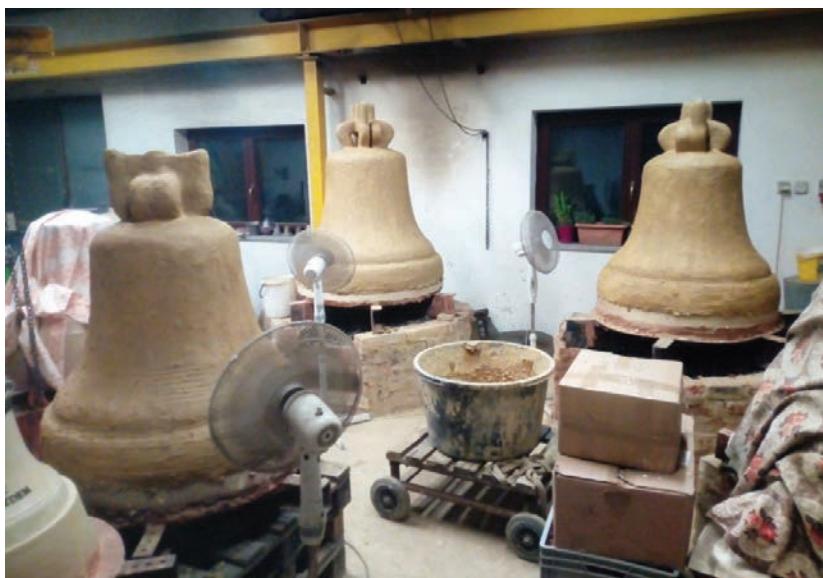
Forma pro odlévání se vyrábí ze speciálně upravené hlíny a skládá se za tři části - jádra (vnitřního profilu zvonu), košile (falešného zvonu, který se před litím odstraní) a pláště (vnějšího profilu zvonu) viz. foto. V příštích dnech se bude forma vypalovat. (11. týden roku 2022)
